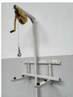
6. Montaggio della staffa con verricello Inserire la staffa premontata con il verricello nell'alloggiamento della barra 4.
