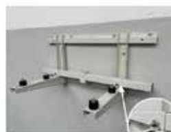
2. Installazione barra 1 Fissare la barra 1 alle braccia delle staffe clima utilizzando gli appositi manicoetti regolabili con dado saldato e i bulloni M10x30.
