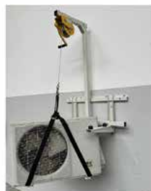
8. Sollevamento e discesa del carico Azionare manualmente la leva del verricello in senso antiorario per svolgere il cavo e consentire la discesa. Ruotare la leva in senso orario per avvolgere il cavo e sollevare la macchina.
