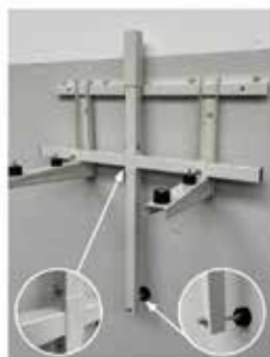
5. Installazione barra 4 e regolazione Inserire la barra 4 nell'alloggiamento centrale della barra 1. Bloccarla inserendo un bullone M10x55 in uno dei quattro fori disponibili, in base all'altezza desiderata. Applicare, nel foro all'estremità, il piede d'appoggio a muro antivibrante e serrarlo accuratamente.
